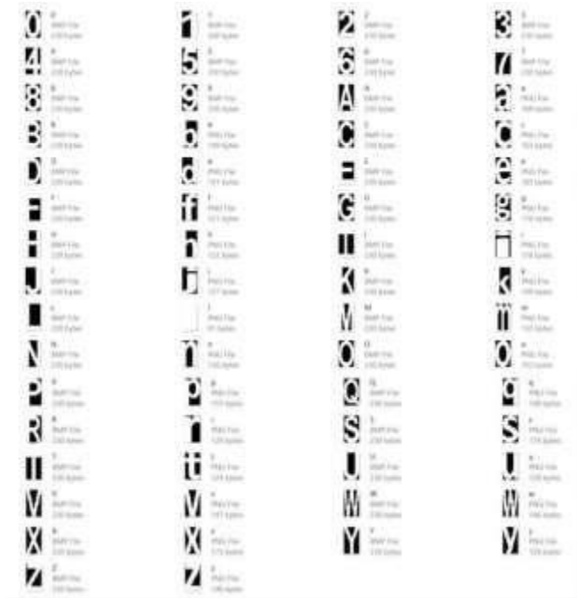
Fig. 4. Template used for Template Matching
